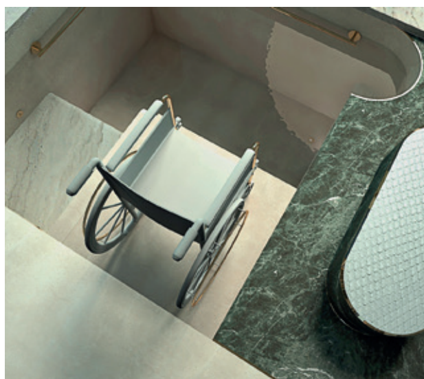
LA VASCA IDROMASSAGGIO È ACCESSIBILE GRAZIE A UNA PEDANA IDRAULICA CHE TRASPORTA LA SEDIA A ROTELLE
